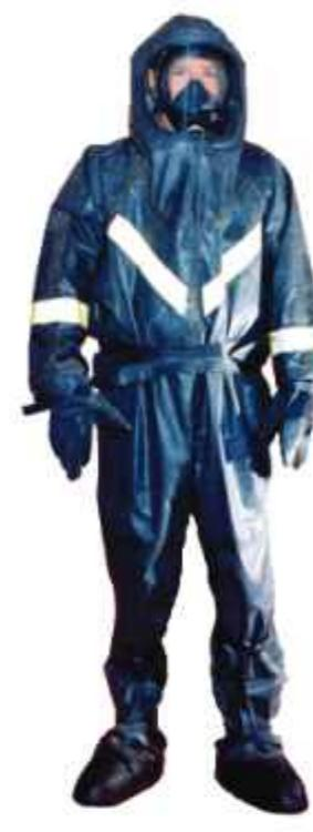
Предназначен для защиты от вредного влияния хлора, аммиака (газообразные и жидкие) при проведении спасательных работ. Костюм выполнен в виде герметичного комбинезона с притачным капюшоном. В лицевую часть капюшона встроено панорамное стекло. КИХ-4М используют в работе вместе с аппаратами на скатом воздухе типа АСВ, АИР-98 МИ-20, АВХ и т.д., а также с противогазом КИП-8
