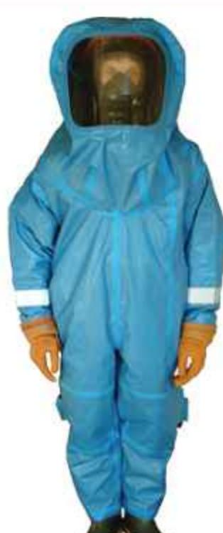
Предназначено для защиты в условиях первой зоны заражения, используется с изолирующими средствами защиты органов дыхания. Конструкция СИЗК-ИП обеспечивает укрытие кожных покровов и герметичность пользователя. Усиление защитных свойств комплекта обеспечивается созданием избыточного давления воздуха, поступающего в подкостюмное пространство
