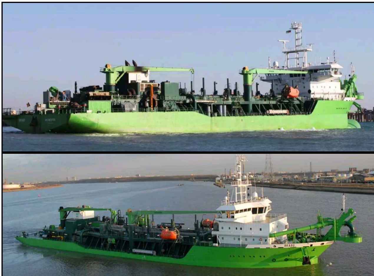
Рисунок 6.1 - Самоотвозный трюмный землесос «Brabo»
