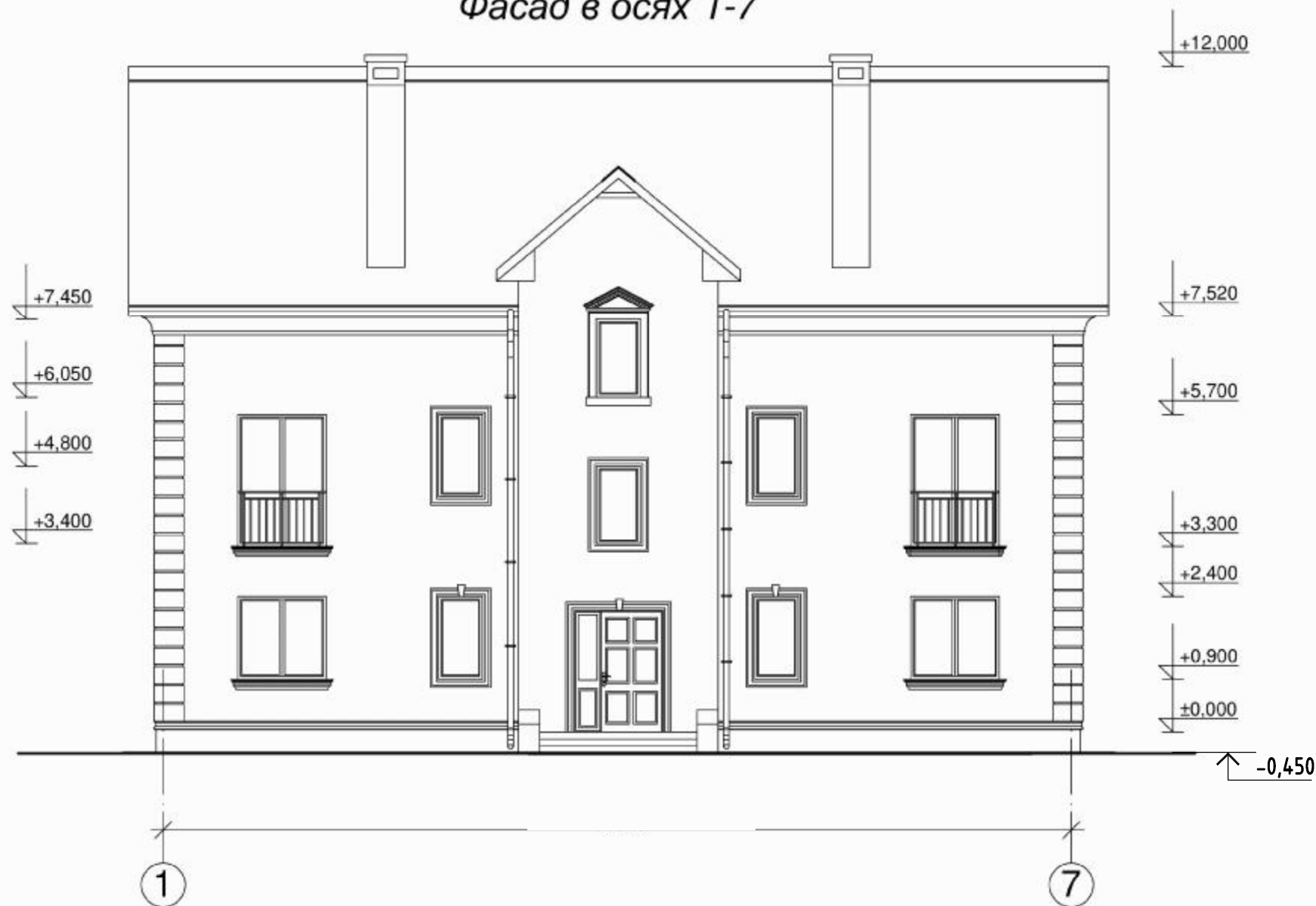
Фасад в осях 1-7
