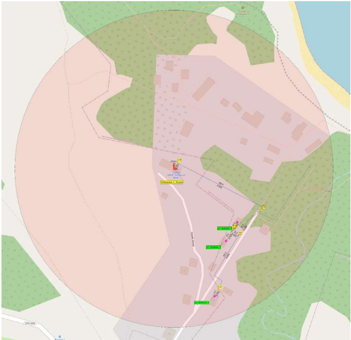
Рисунок 73. Радиус эффективного теплоснабжения котельной п. Филино
