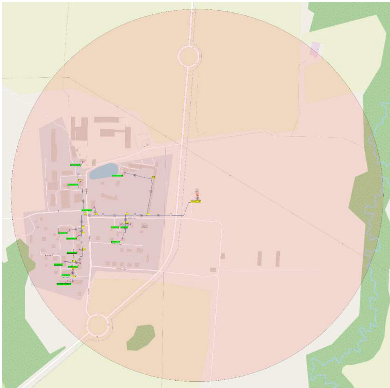
Рисунок 12 Радиус эффективного теплоснабжения котельной п. Зори
