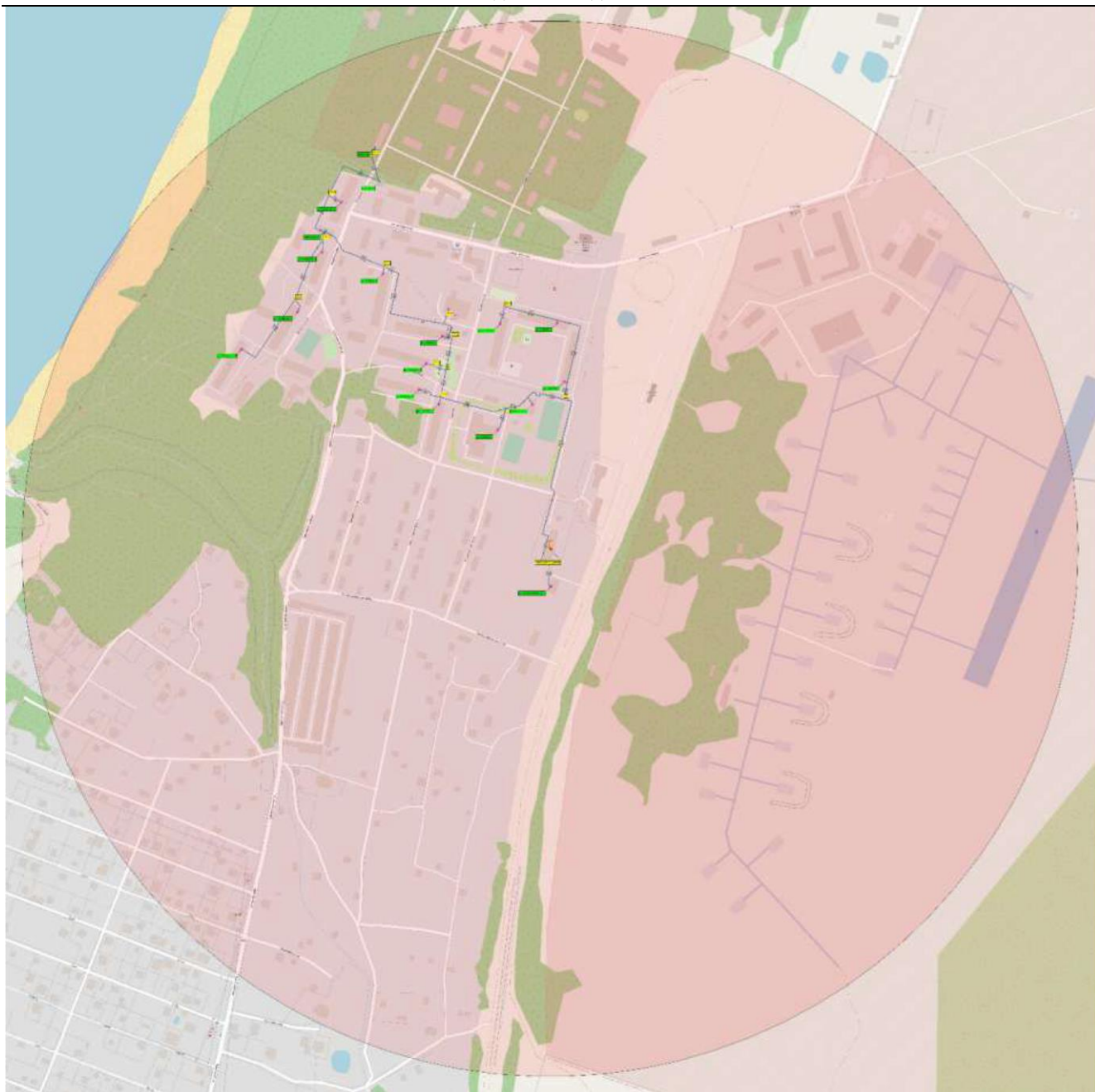
Рисунок 17 Радиус эффективного теплоснабжения котельной п. Донское
