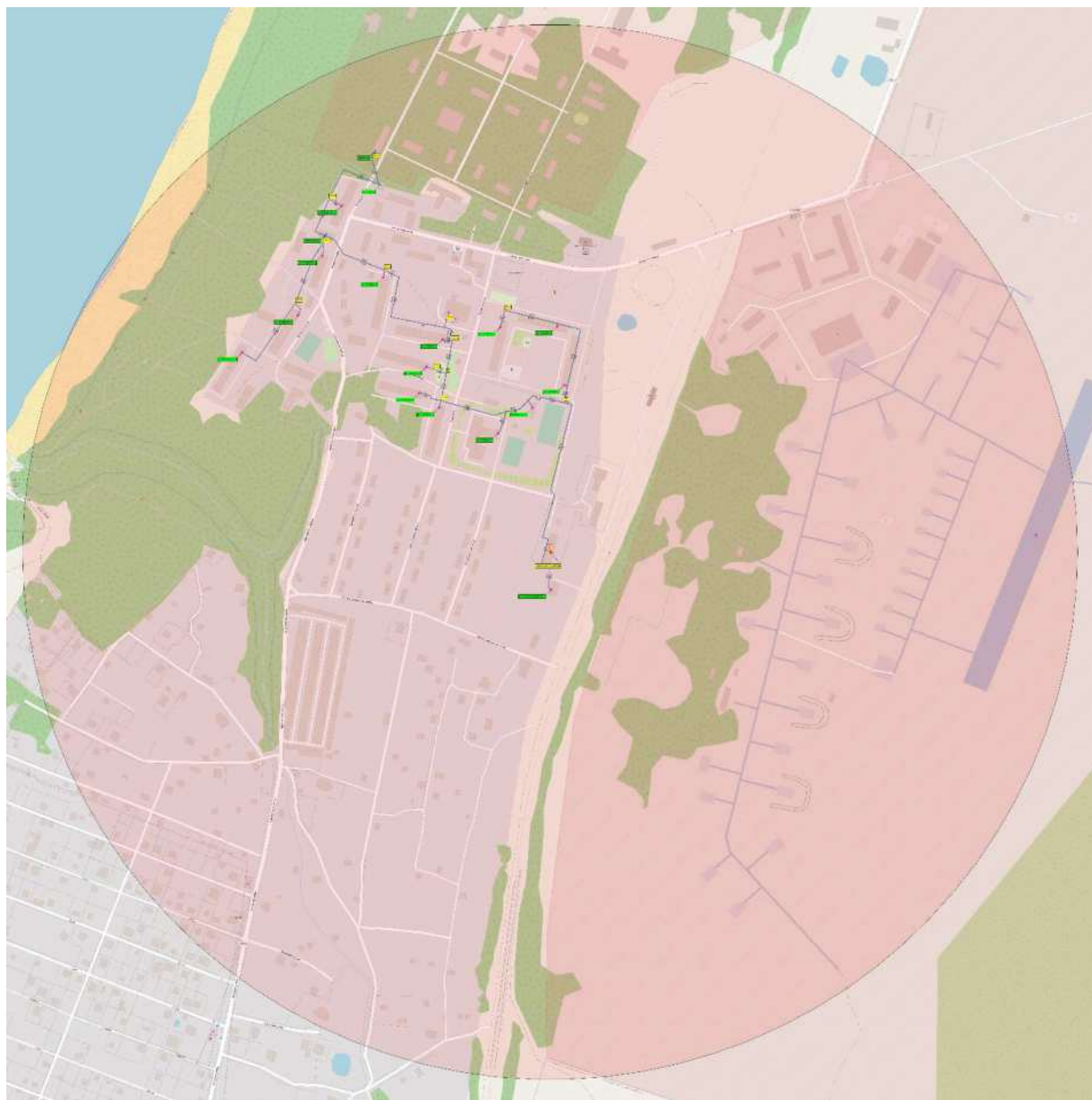
Рисунок 17. Радиус эффективного теплоснабжения котельной п. Донское
