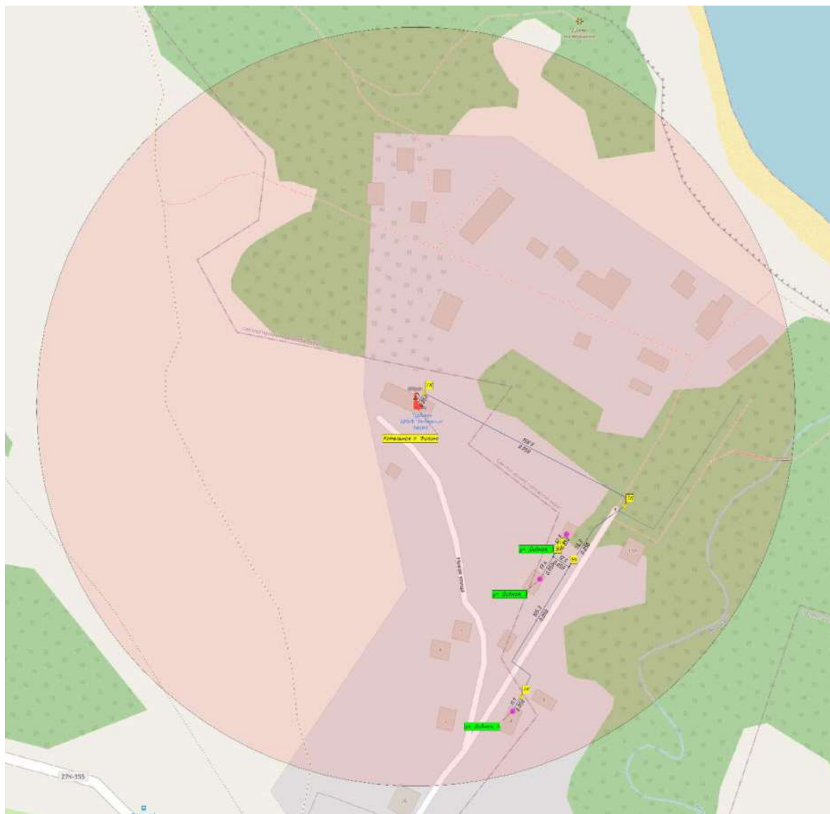
Рисунок 18. Радиус эффективного теплоснабжения котельной п. Филино
