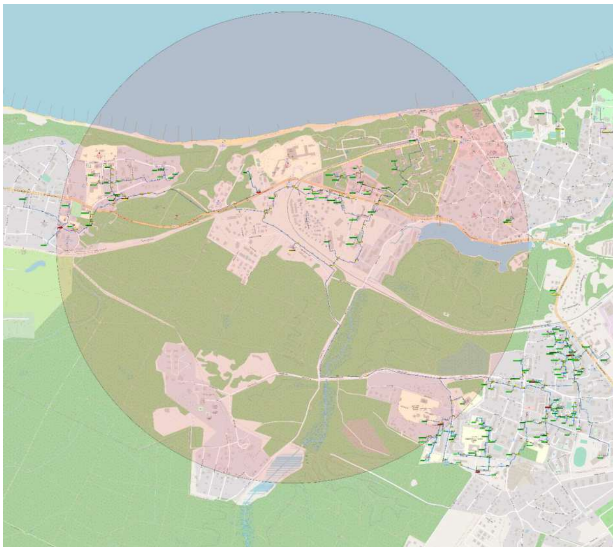
Рисунок 11. Радиус эффективного теплоснабжения РТС «Светлогорская»
