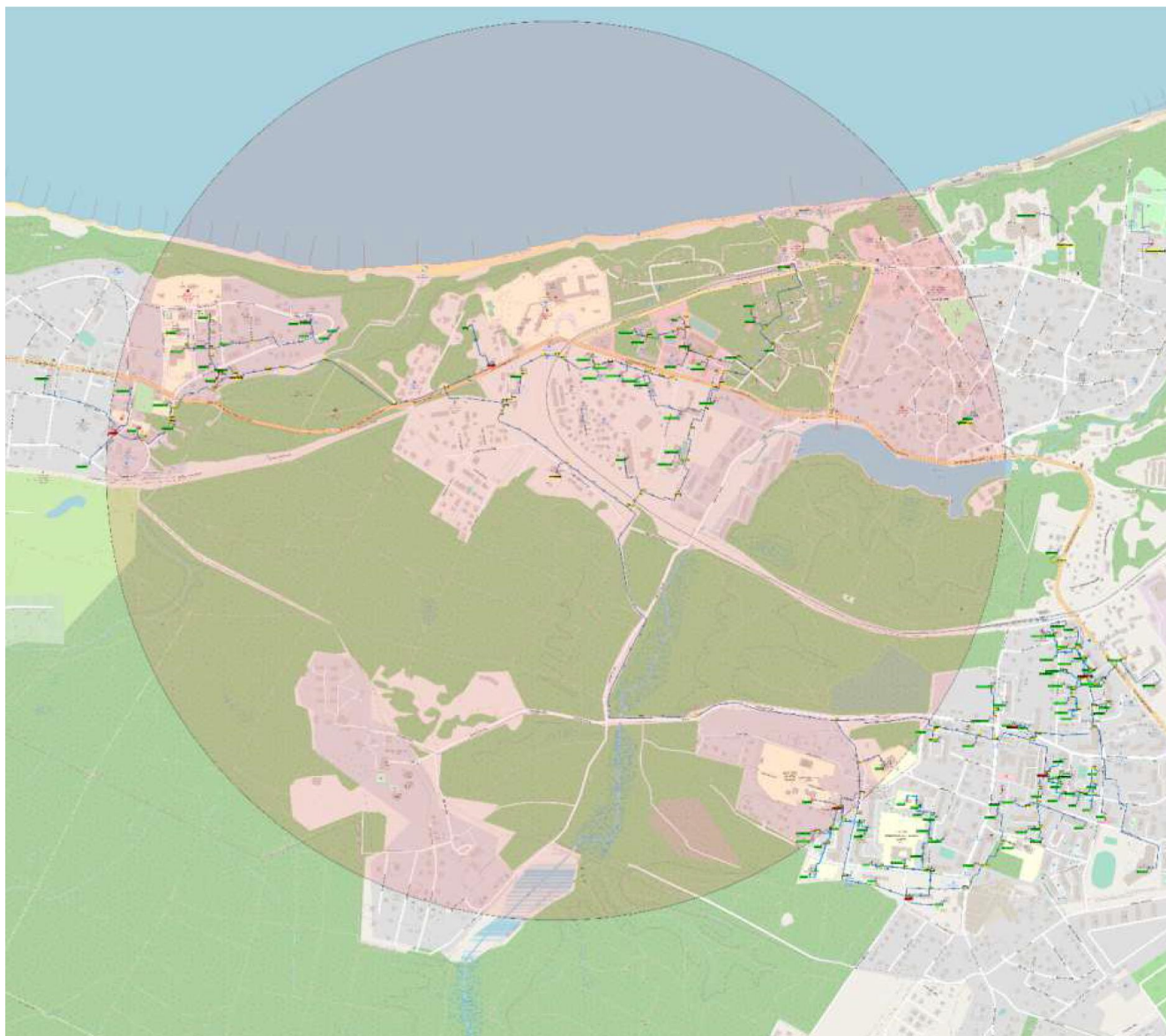
Рисунок 65 Радиус эффективного теплоснабжения РТС «Светлогорская»
