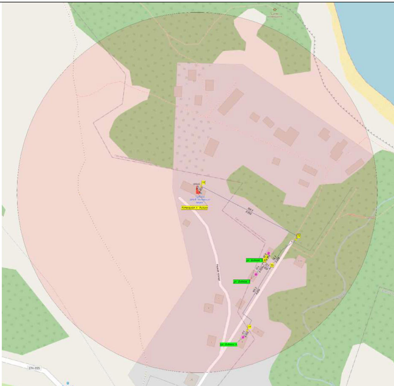
Рисунок 72 Радиус эффективного теплоснабжения котельной п. Фирино
