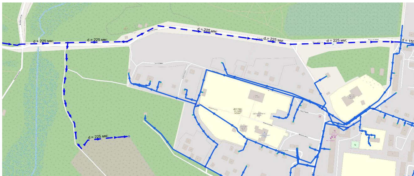
Рисунок 21 Строительство сети водоснабжения от пос. Майский до точки подключения по ул. Новая (ул. Солнечная, ул. Песочная) в Светлогорском городском округе Калининградской области - 225 мм
