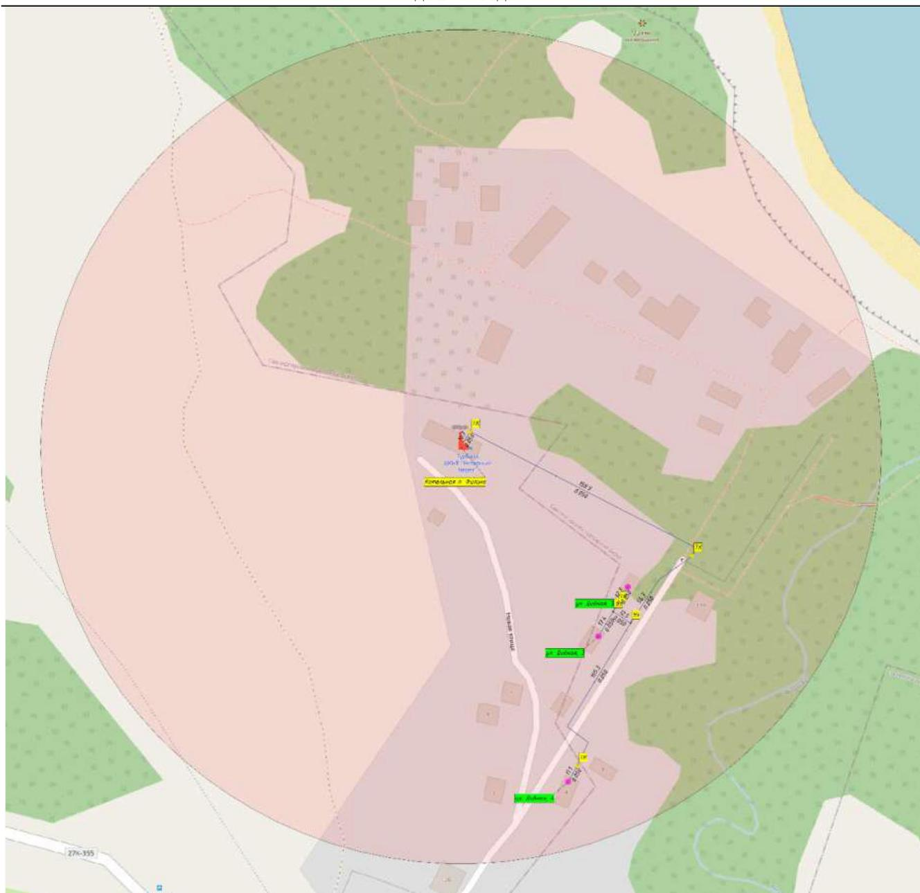
**Рисунок 18 Радиус эффективного теплоснабжения котельной п. Фирино**
