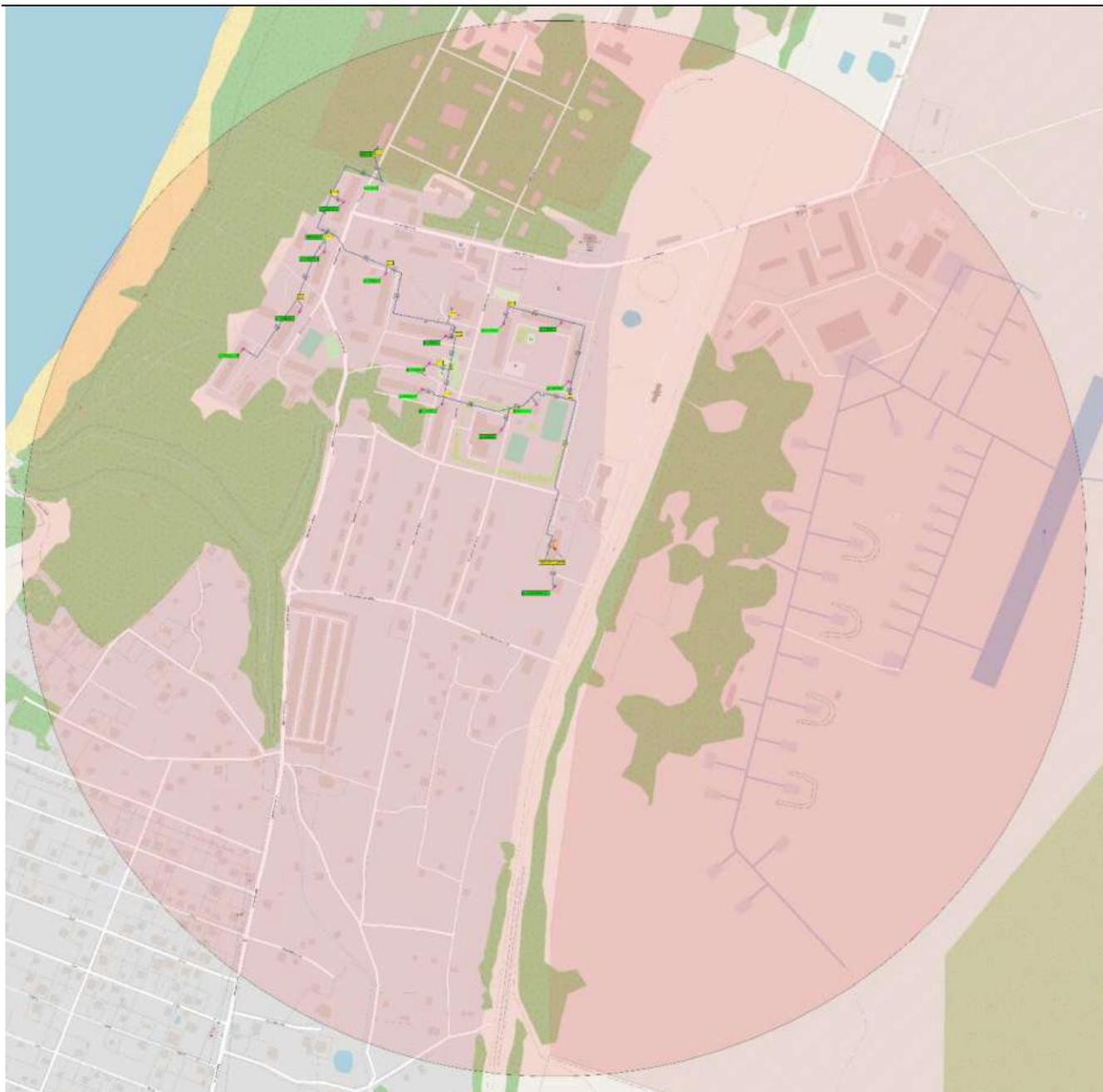
**Рисунок 17 Радиус эффективного теплоснабжения котельной п. Донское**
