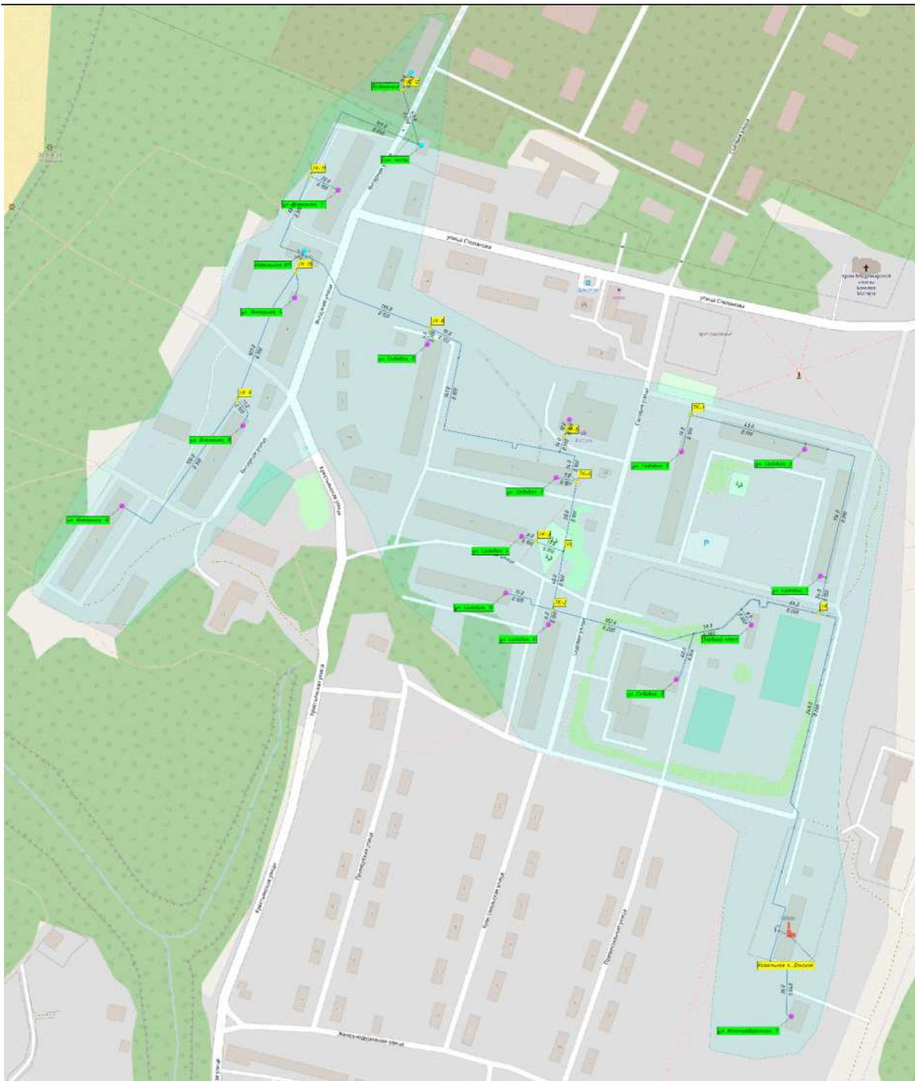
Рисунок 9. Зона действия котельной п. Донское
