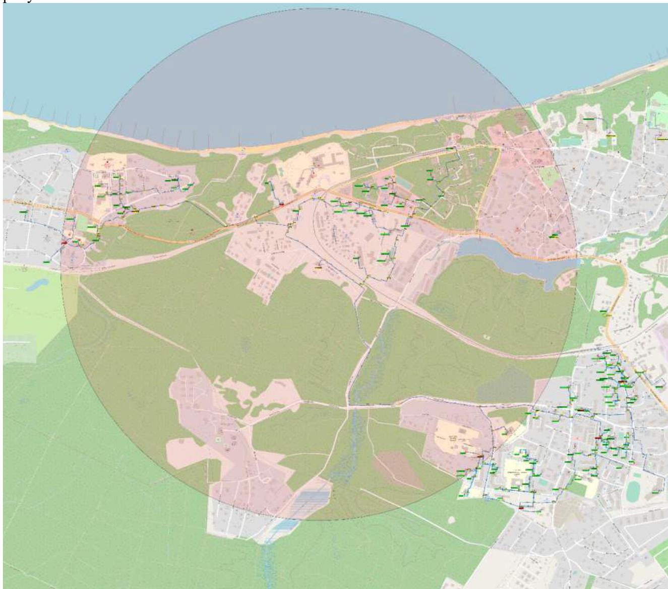
**Рисунок 11 Радиус эффективного теплоснабжения РТС «Светлогорская»**
